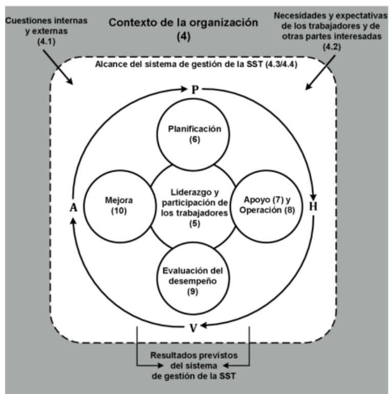
Figura N° 9: Relación entre el PHVA y el marco de referencia de la ISO 45001
