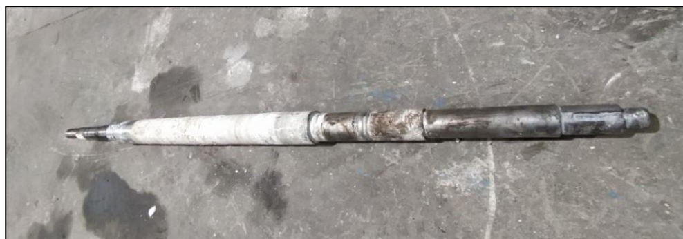
Eje de transmisión desmontado
