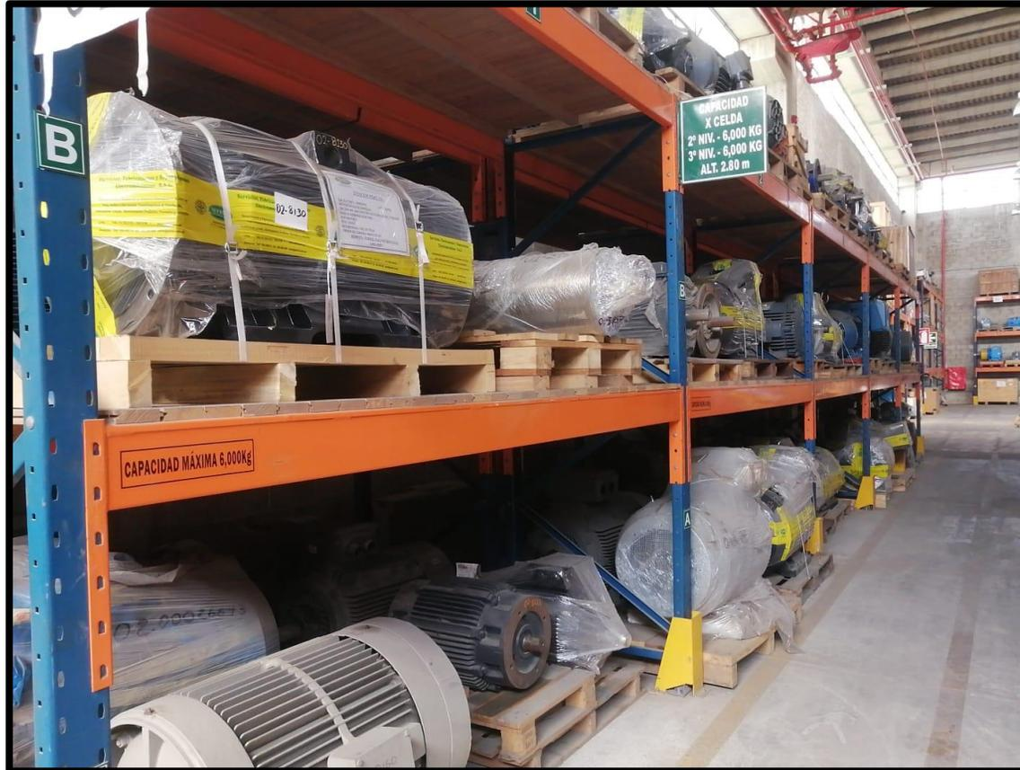
Análisis: Aquí se aprecia la introducción de protección a las piezas de gran calibre, éstas serán protegidos con fill, enzunchados en sus respectivos pallets y etiquetados
