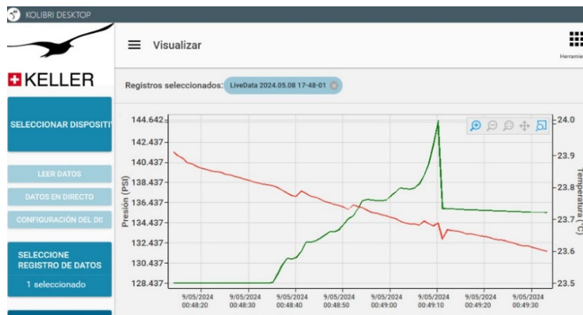
Figura 4.26 Generación de graficas de la prueba de presión de la válvula
