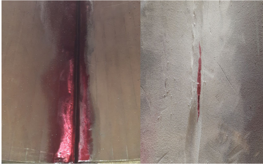
Figura 2.22 Aplicación de tintes penetrantes a pase raíz de soldadura
