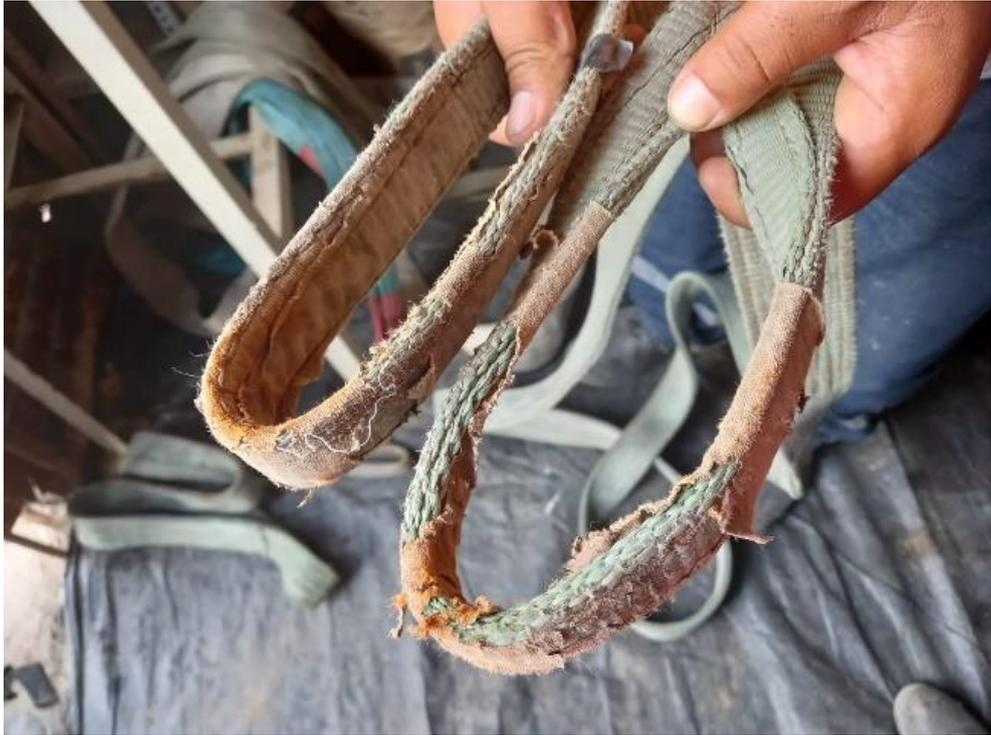
**Figura 07:** *Eslingas en mal estado*
