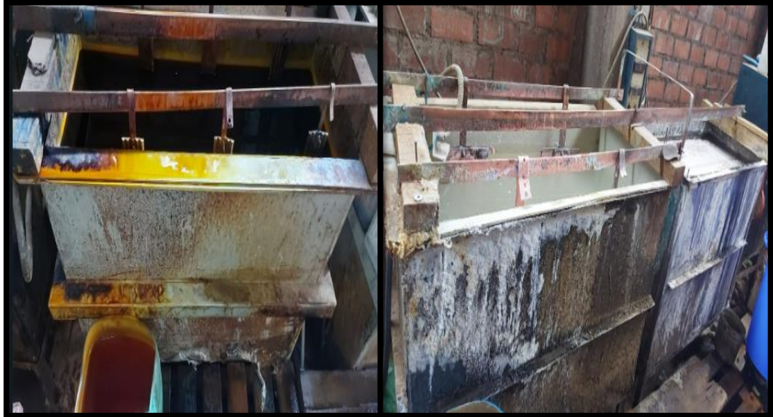
Figura 14: Falta de mantenimiento de las máquinas
