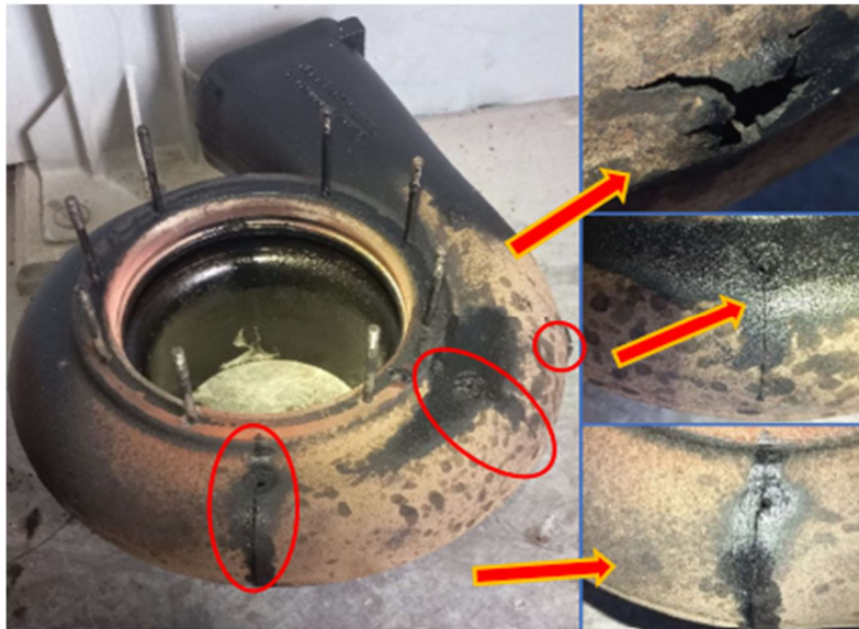
Figura A21 Turbo dañado
