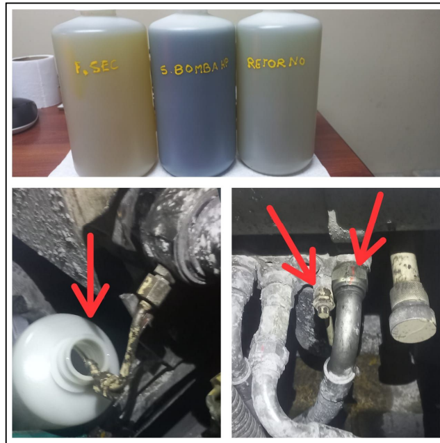
Figura A3. Extracción de muestras de combustible
