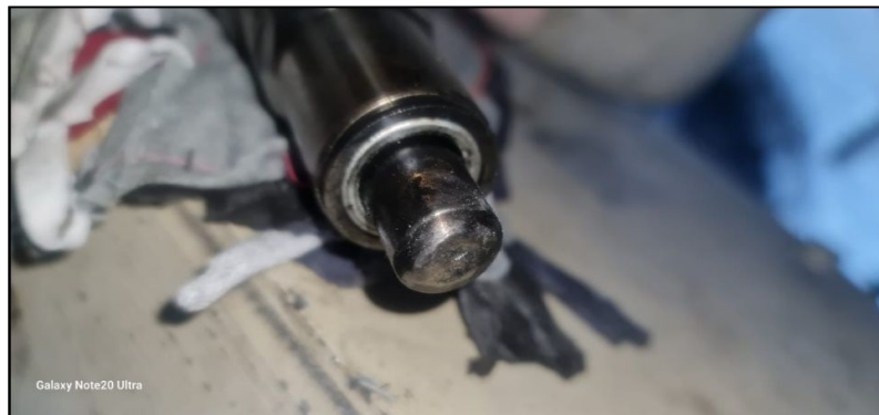
Figura A22 Inyector Dañado
