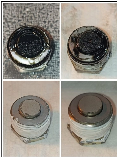
Figura A10. Inspección de pernos de cárter
