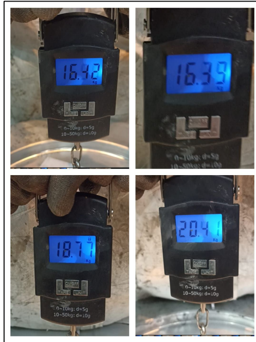
Figura A5. Inspección de Filtros de aire - Pesos de filtros
