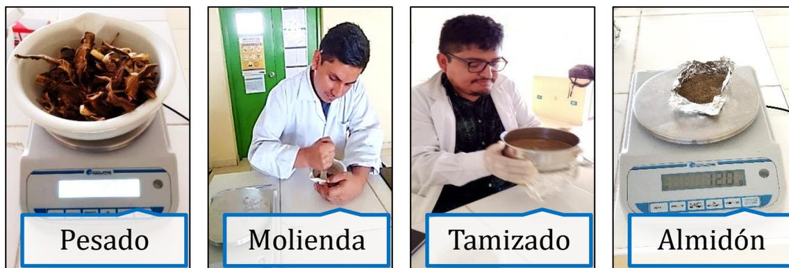
Paso 3: Elaboración del bioplástico obtenido a partir de la cáscara de plátano verde
