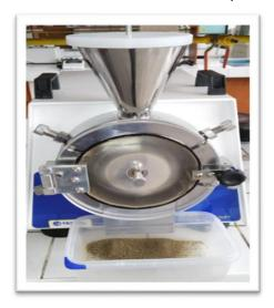
Nota: La molienda se realizó en el laboratorio de Investigación, Desarrollo e Innovación con el Macro molino (TERNAL TE-650/1 – Molino tipo WILEY).
