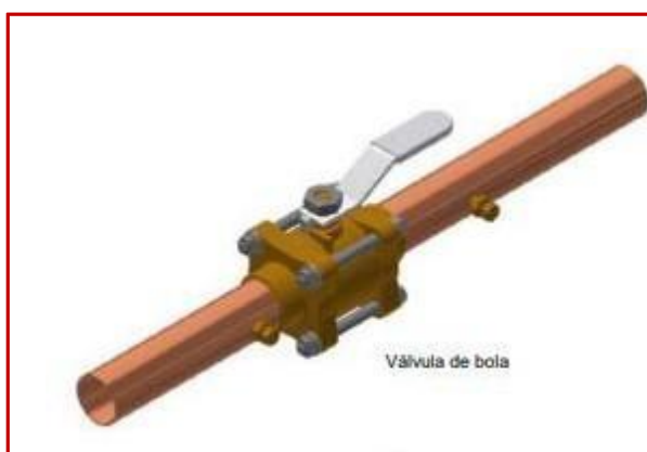
Figura 3.2. Válvulas de Corte
