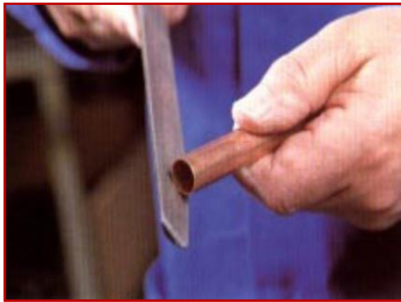
Figura 3.27. Limado de tubería
