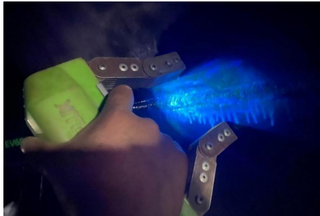
Figura 2.13 Ensayo de partículas magnéticas fluorescentes a cordón de soldadura interno de recipiente a presión
