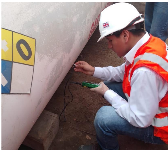
Figura 2.15 Medición de espesores por ensayo de ultrasonido a recipiente a presión estacionario
