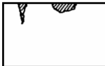
Figura 2.8 Corrosión por picado
