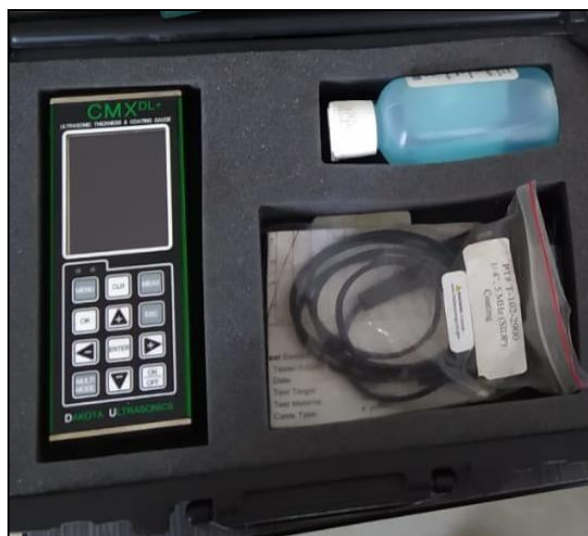
Figura 2.14 Equipo de medición de espesores marca Dakota
