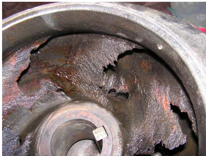
Figura 2.19 Erosión-corrosión del impulsor de hierro fundido de bomba de agua
