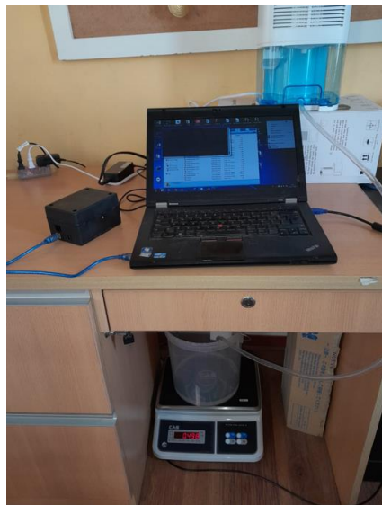
Fig. 29. Sistema de medición para obtener agua del medioambiente con equipo Peltier. Fuente: implementación propia
