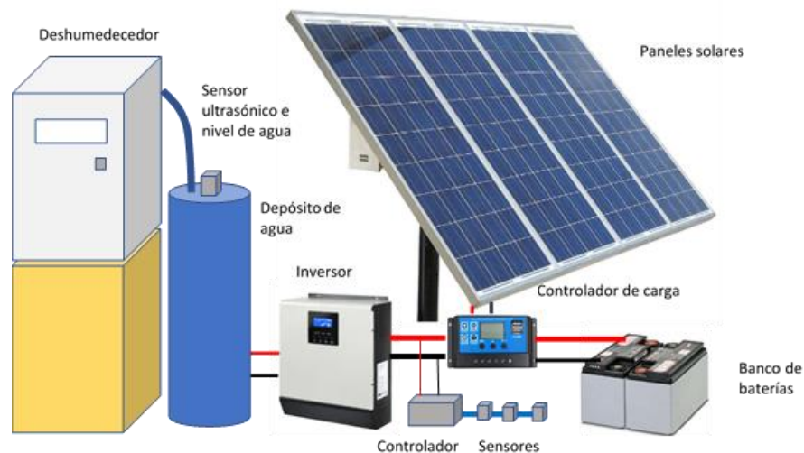
Fig. 46. Modelo de tecnologías eficientes de energía solar-humedad del ambiente para la obtención de agua con el propósito de investigación. Fuente: elaboración propia
