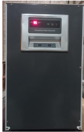
Fig. 26. Sistema de medición para obtener agua del mediamente con equipo WFAR electromecánico. Fuente: implementación propia
