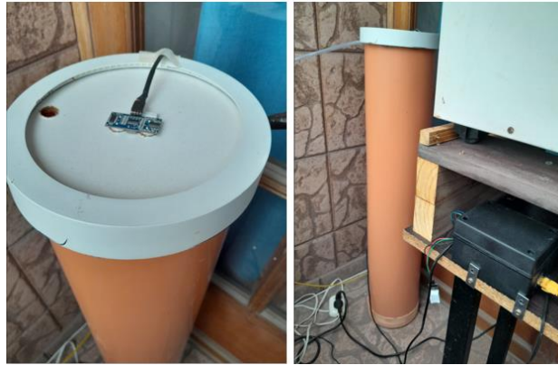
Fig. 24. Dispositivo de captación y medición de volumen obtenido de agua mediante sensor de distancia por ultrasonido. Fuente: implementación propia
