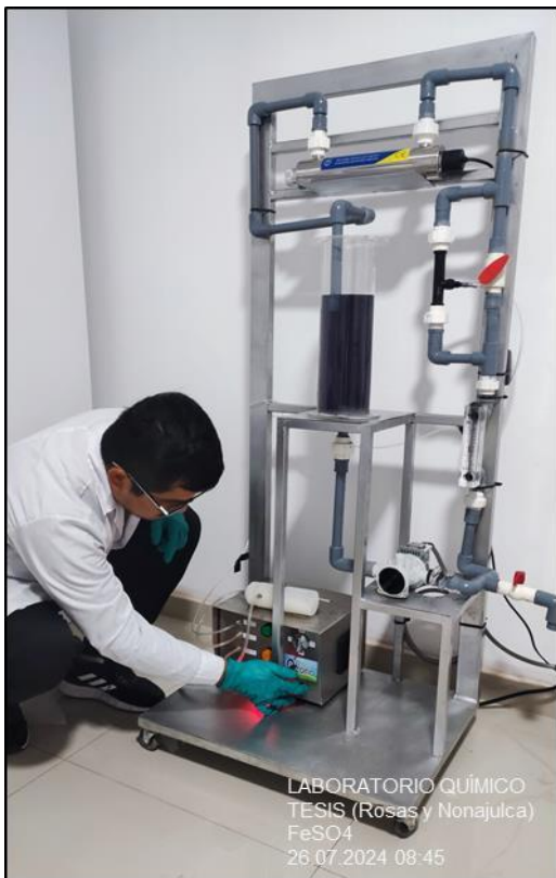
Armado del sistema de foto-Fenton con ozono
