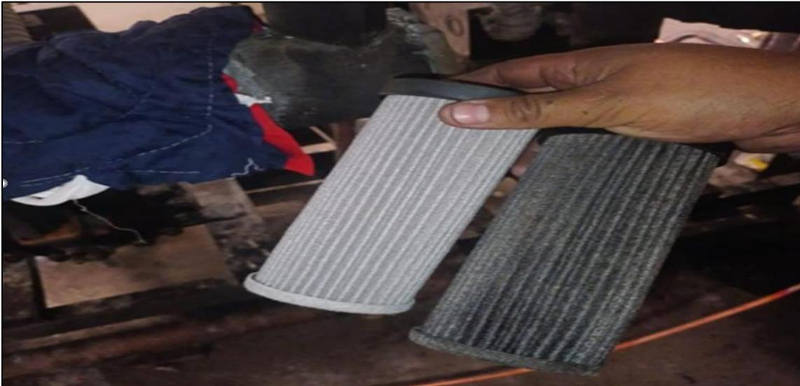
Figura 3.27 Filtros de succión en rack de frío
