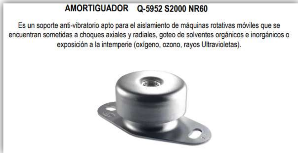
Figura 3.13: Ficha Técnica de Amortiguador NR60
