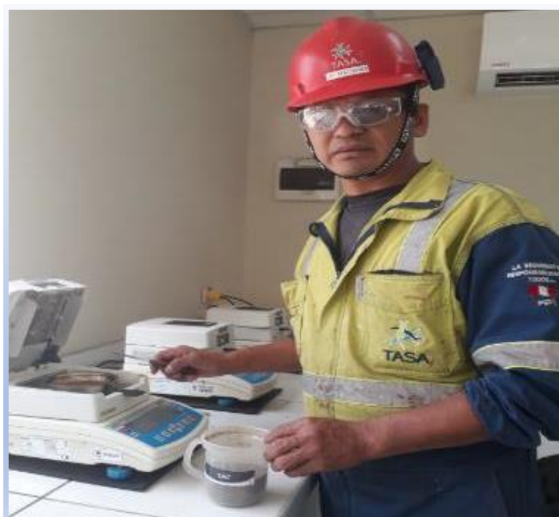
Figura 34. Análisis de la humedad por termobalanza, Planta Tasa Végueta.
