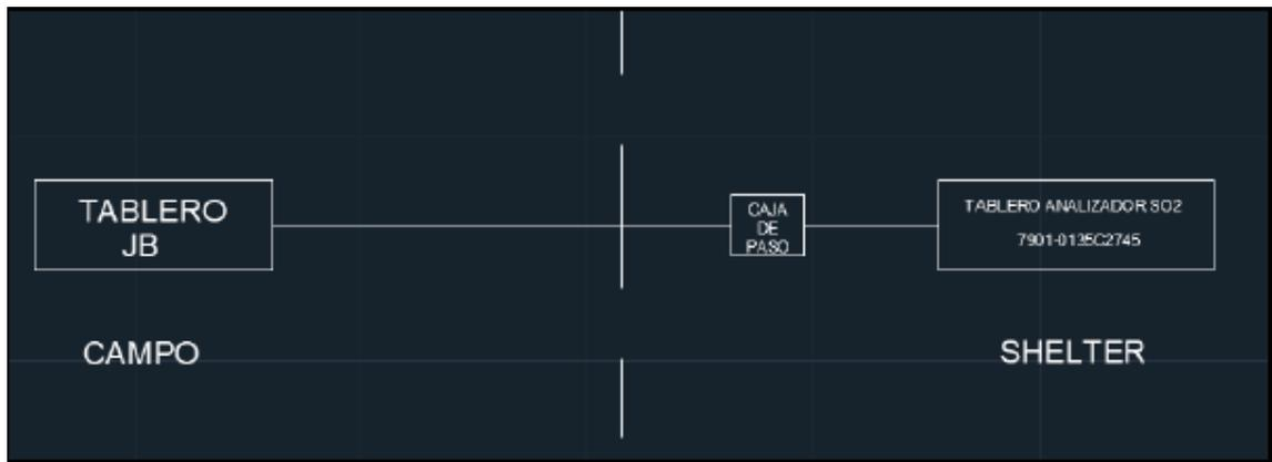
Figura 12. Ruta del cable de control al Shelter
