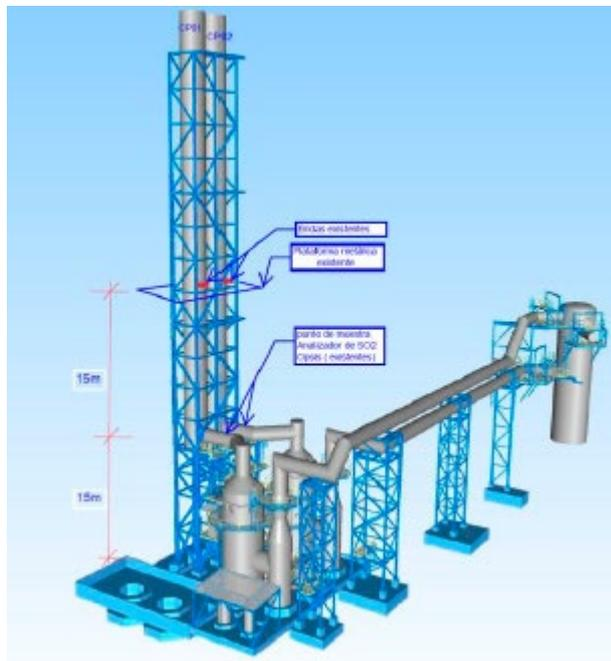
Figura 3. Estructura de la planta lavador de gases
