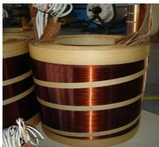
Figura 5: Bobinado de AT de transformador
