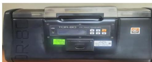
Figura 26: Instrumento de medición: Espinterómetro GlobeCore TOR-80, N° 0144
