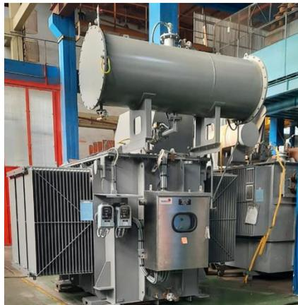
Figura 1: Transformador de distribución
