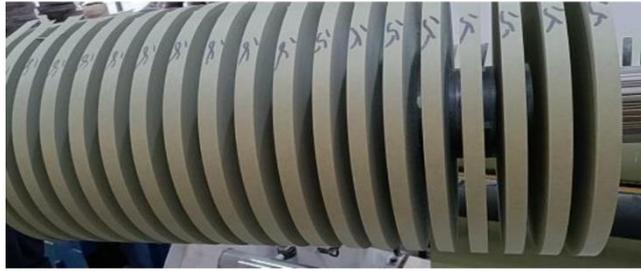
Figura 17: Cinta Kraft para forrado de la pletina de BT
