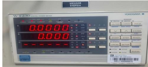
Figura 82: Instrumento de medición: Vatímetro WT230 Yokogawa, N° 91MB6815 mide la potencia, pérdidas en el hierro y cobre
