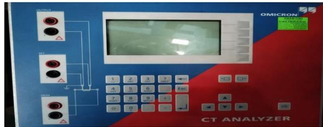
Figura 73: Instrumento de medición:CT ANALYZER
