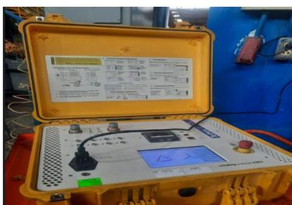
Figura 28: Instrumento de medición: Analizador Tettex 2293, N° 180847
