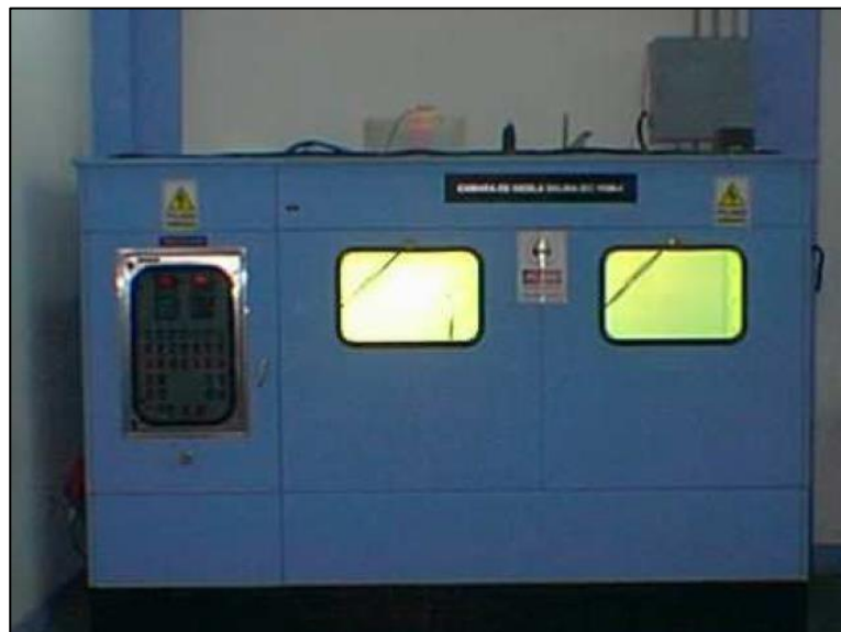
Figura 11: Cámara de niebla salina en la que se realizaron las pruebas
