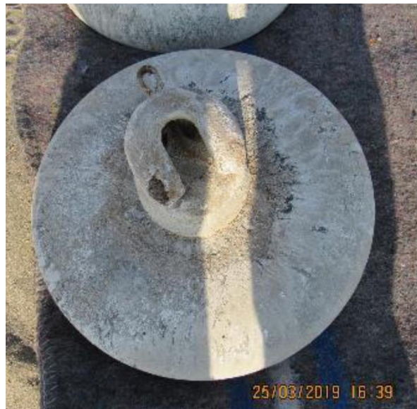
Figura 37: T02 de la línea L5011, aislador con grasa silicona aplicado sobre la goma silicona
