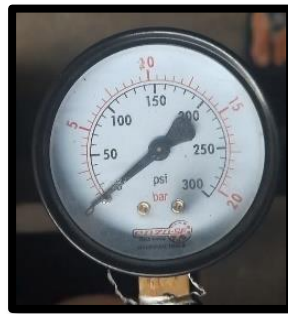
Figura 4.4 Manómetro con escala de 0-300 psi.
