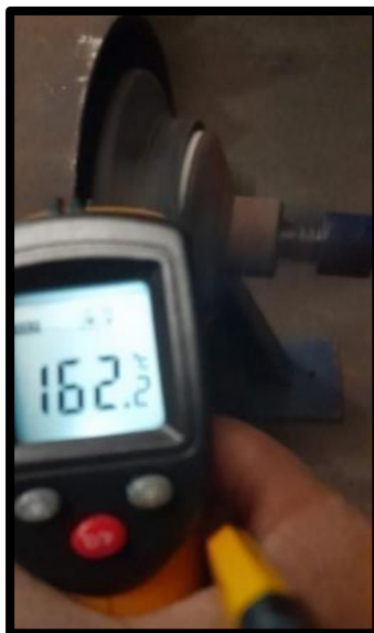
Figura 4.25 medición de temperatura en ubicación de tapa de teflón
