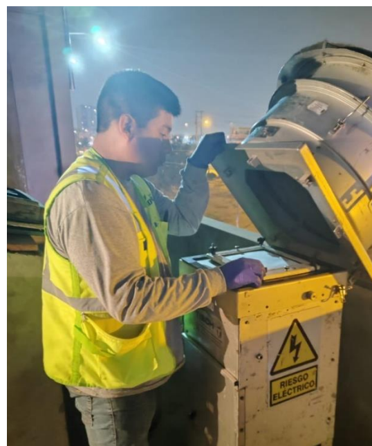
Cambio de filtros de PM 2.5
